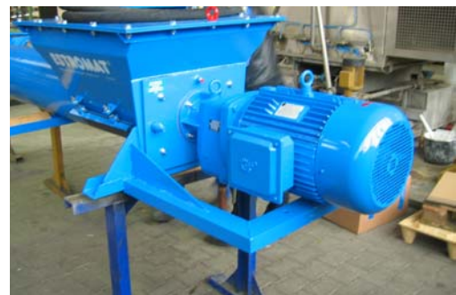
Verschiedene Getriebemotoren mit einer Leistung von 7,5 bis zu 45kW sind lieferbar für spezielle Anwendungen entsprechend dem zu mischenden Material
