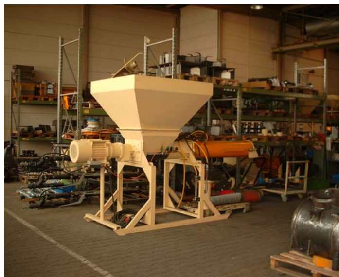
Durchlaufmischer ESTROMAT 403 mit Explosionsgeschütztem Getriebemotor für Anwendungen in der Chemischen Industrie
