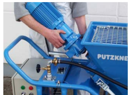
Der Pumpenmotor wird zur Reinigung das Mischrohrs abgeklappt. Zum Transport wird er abgenommen.
