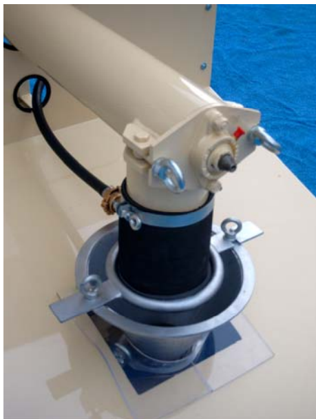
Sicht auf Mischtrichter mit Wasserring
